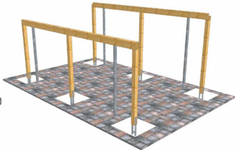
Bohren Sie die Pfosten vor und verschrauben Sie diese mit den Pfostenankern. Stellen Sie die Pfosten auf und verschrauben Sie diese von oben mit zwei Tellerkopfschrauben an die Fußpfette
